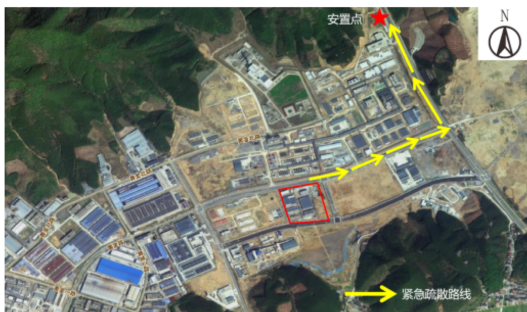
图 1.7-1 厂内/外应急疏散通道路线图
