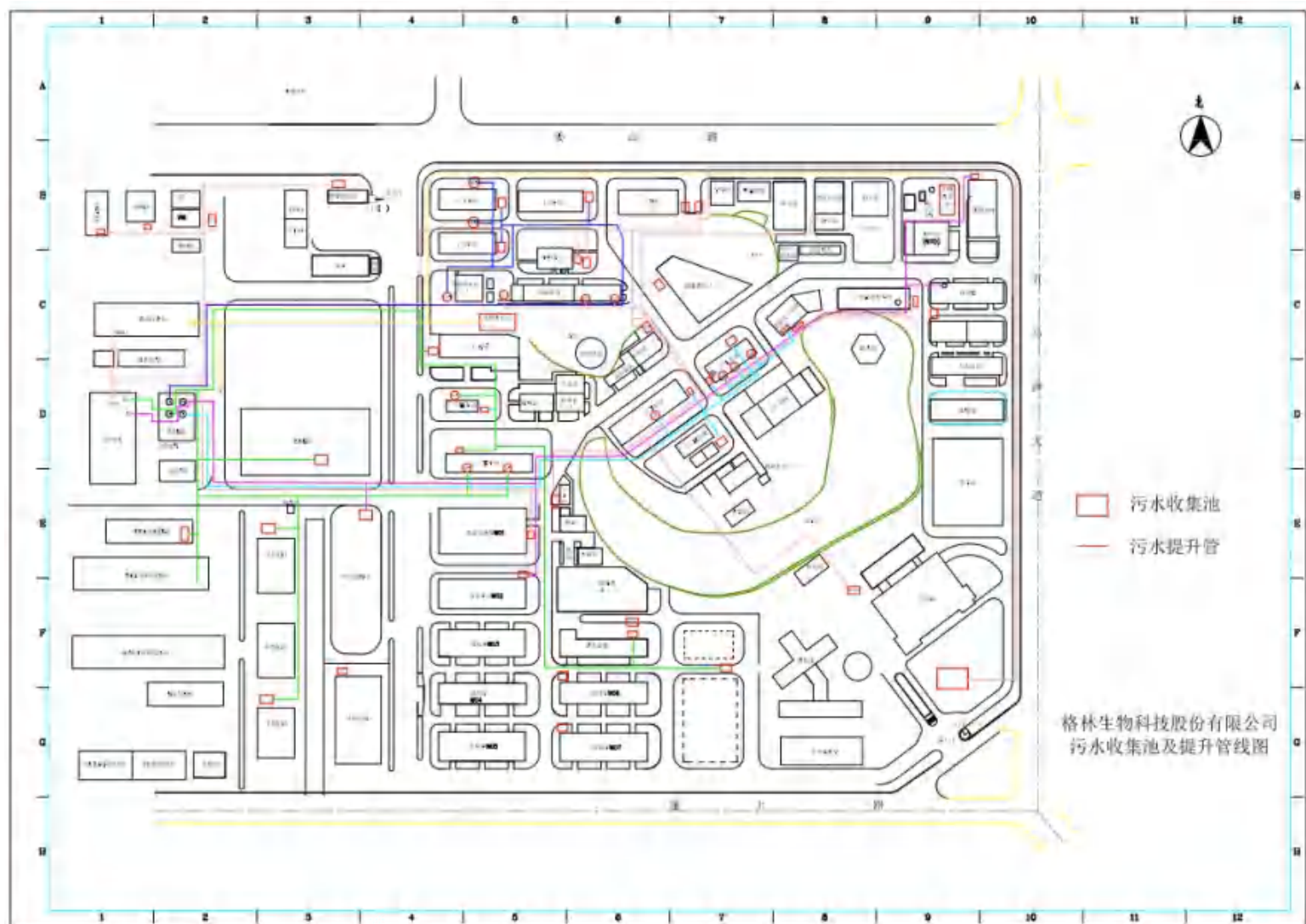
附图5 厂区污水管线布置示意图
