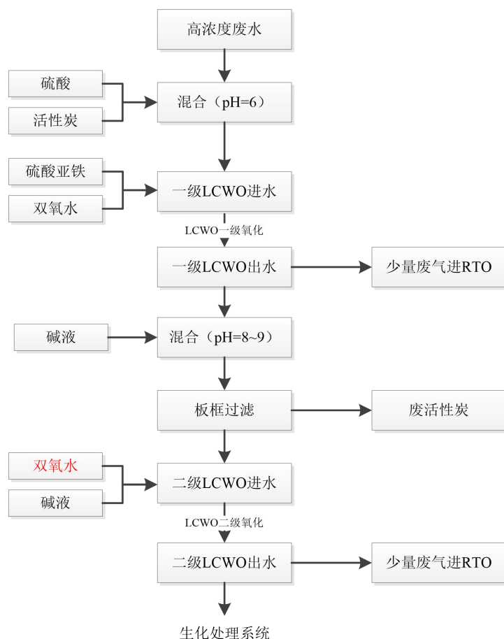
图 3.3-2 高浓废水预处理工艺流程图
