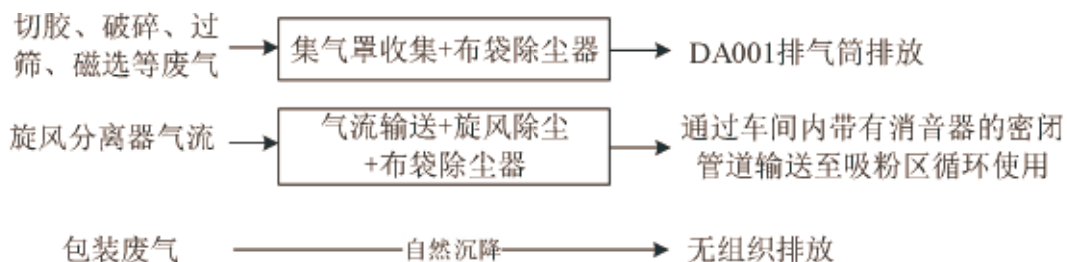
图 4.2-4 本项目废气处理流程简图
