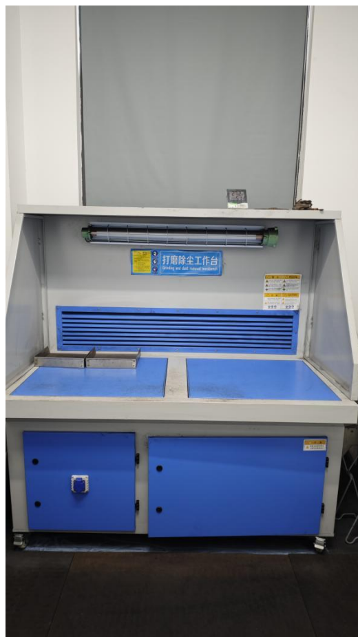
打磨除尘工作台
