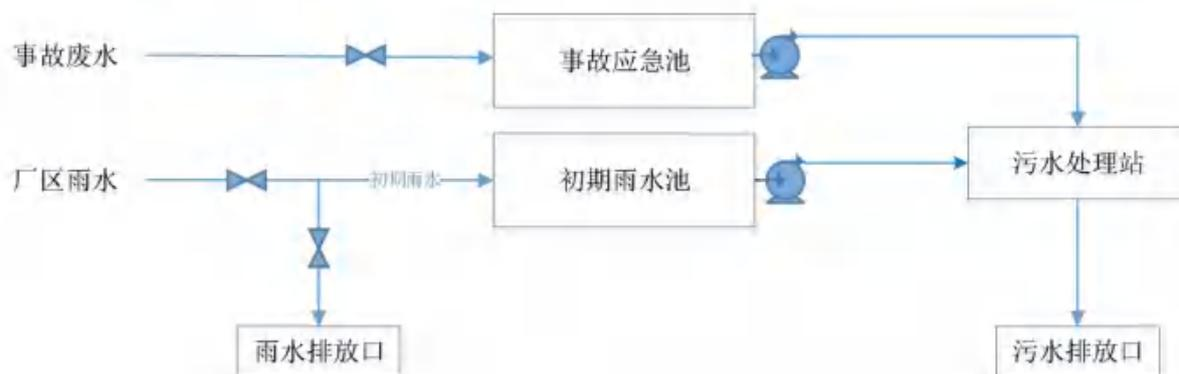
图 6.7.6-2 本项目事故水收集系统流程示意图
