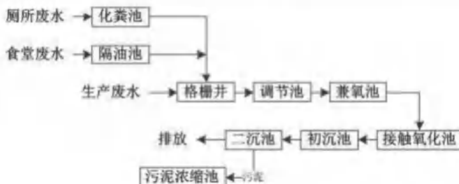
图 4.2-2 厂区污水处理站处理工艺流程简图
