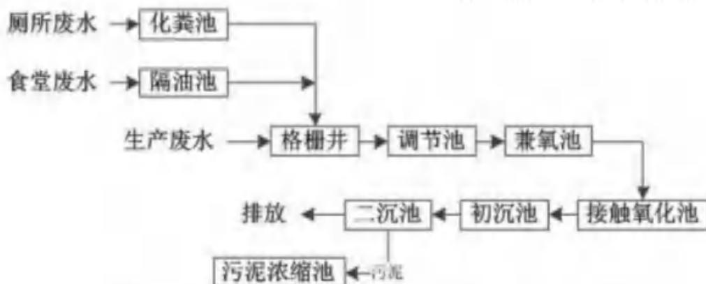
图 2.5-8 自有厂区污水处理工艺流程简图
