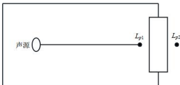
图 4.2-4 室内声源等效为室外声源图例
