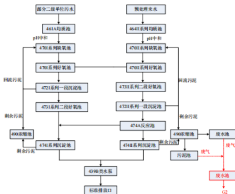
图 5-2-1 一期工程废水预处理工艺流程
