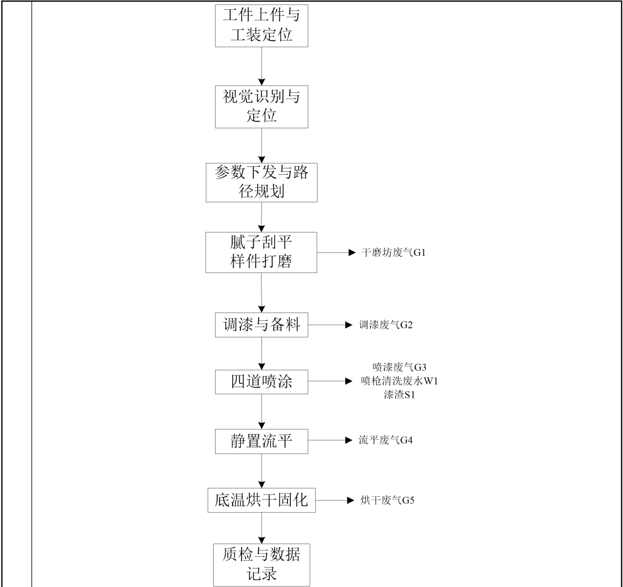
图 2-4 智能喷涂机器人研发工艺流程图
